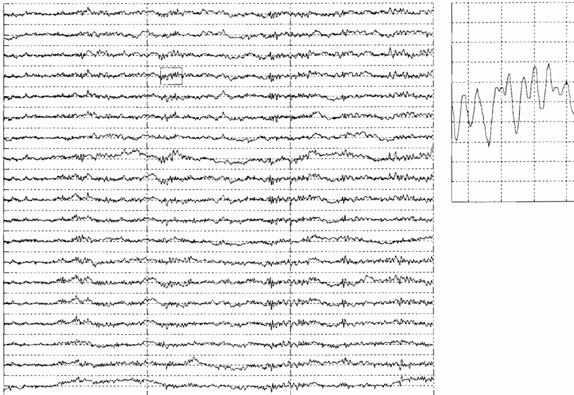
Рис.4. Увеличение разрешения и повышение частоты дискретизации позволяет проводить анализ низкоамплитудных составляющих ЭЭГ.
